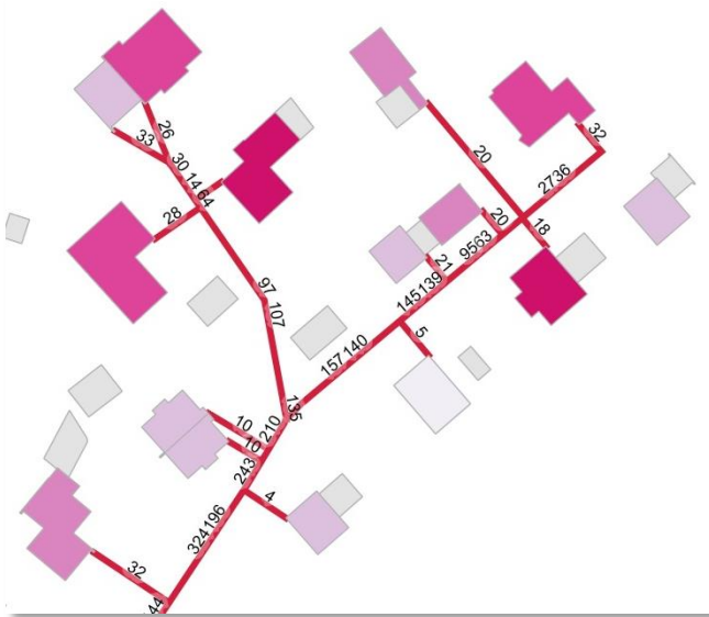
Abbildung 4: Schematische Darstellung zur Ermittlung der Wärmebelegungsichte auf (theoretischen) Trassenabschnitten
