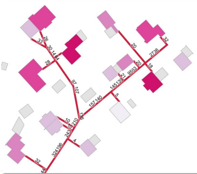
Abbildung 4: Schematische Darstellung zur Ermittlung der Wärmebelegungsdichte auf (theoretischen) Trassenabschnitten
