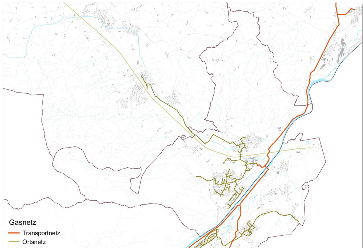
Abbildung 2: Netzinfrastruktur Gas (Transport- und Ortsnetz)
