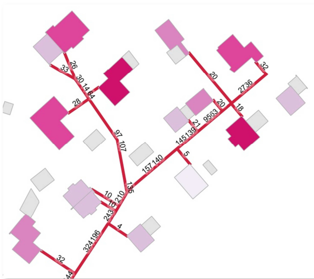
Abbildung 5: Schematische Darstellung zur Ermittlung der Wärmebelegungsichte auf (theoretischen) Trassenabschnitten
