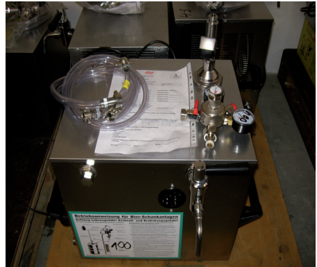
Abb. 12: Nicht verwendungsfertige Getränkeschankanlage
